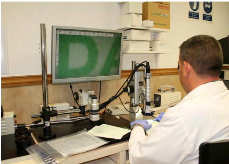
Macroscopio de alta resolución para análisis de documentos.
